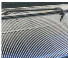
Cuchillas Extraíbles Espaciadas 15mm
