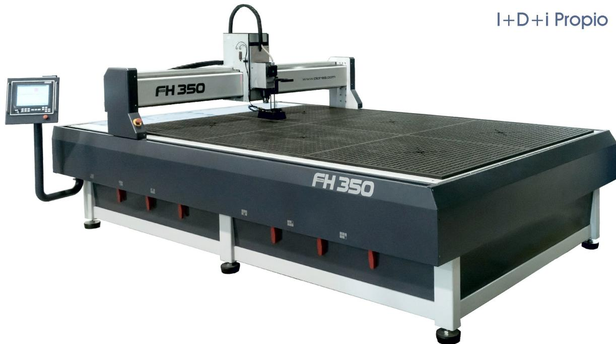
Modelo de gran formato para producción y carga intensiva de trabajo en mecanizados donde se requieran prestaciones tanto de potencia como de precisión. Muy robusta y con bajo mantenimiento, características de toda la serie FH. Con transmisión por husillos a bolas en todos los ejes con nuestro exclusivo sistema de tuerca rotativa, motores servos y cambiador automático de herramientas en opción. Área útil de trabajo de 305x205cm y altura de 150mm.
