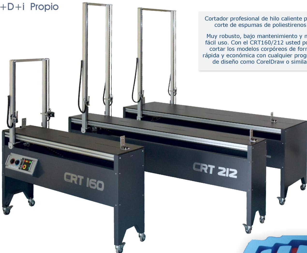
Cortador profesional de hilo caliente para corte de espumas de poliestirenos.
