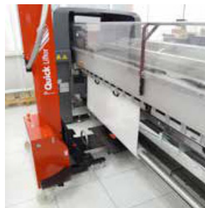
Cargue las bobinas directamente desde el bastidor o suelo.
