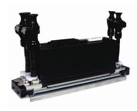
Cabezal de impresión industrial Kyocera de alta velocidad, frecuencia de encendido de 30KkHz, gota de 4pl, resolución de impresión 635x2400dpl. Cabezal de impresión de doble color, función de calefacción interna para mantener la constancia de la viscosidad de tinta. Ancho de banda de impresión de 112,35 mm, un solo nozzle puede imprimir 40.000 microgotas por segundo, por lo que un solo cabezal puede imprimir más de 1 billón de gotas por segundo.
