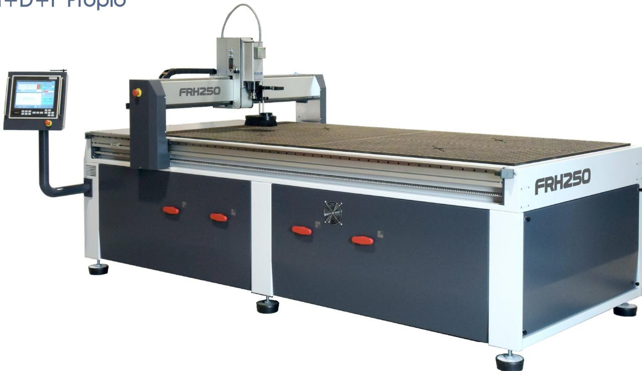
Modelo de producción para mecanizados donde se requieran prestaciones tanto de potencia como de precisión. Muy robusta y con bajo mantenimiento, características de toda la serie FRH. Con transmisión por husillos a bolas en todos los ejes con nuestro exclusivo sistema de tuerca rotativa y cambiador automático de herramientas en opción. Área útil de trabajo de 245x125cm y altura de 120mm.
