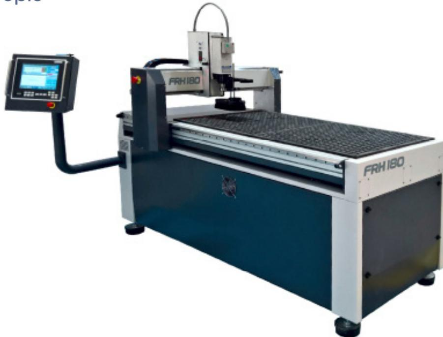
Modelo de producción para mecanizados donde se requieran prestaciones tanto de potencia como de precisión. Muy robusta y con bajo mantenimiento, características de toda la serie FRH. Con transmisión por husillos a bolas en todos los ejes con nuestro exclusivo sistema de tuerca rotativa y cambiador automático de herramientas en opción. Área útil de trabajo de 140x74cm y altura de 120mm.
