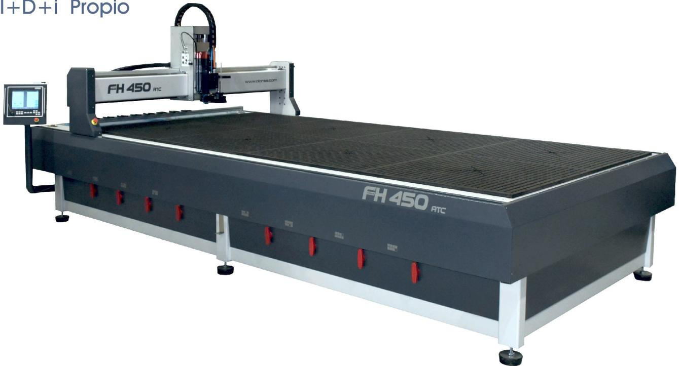
Modelo de gran formato para producción y carga intensiva de trabajo en mecanizados donde se requieran prestaciones tanto de potencia como de precisión. Muy robusta y con bajo mantenimiento, características de toda la serie FH. Con transmisión por husillos a bolas en todos los ejes con nuestro exclusivo sistema de tuerca rotativa, motores servos y cambiador automático de herramientas en opción. Área útil de trabajo de 405x205cm y altura de 150mm.
