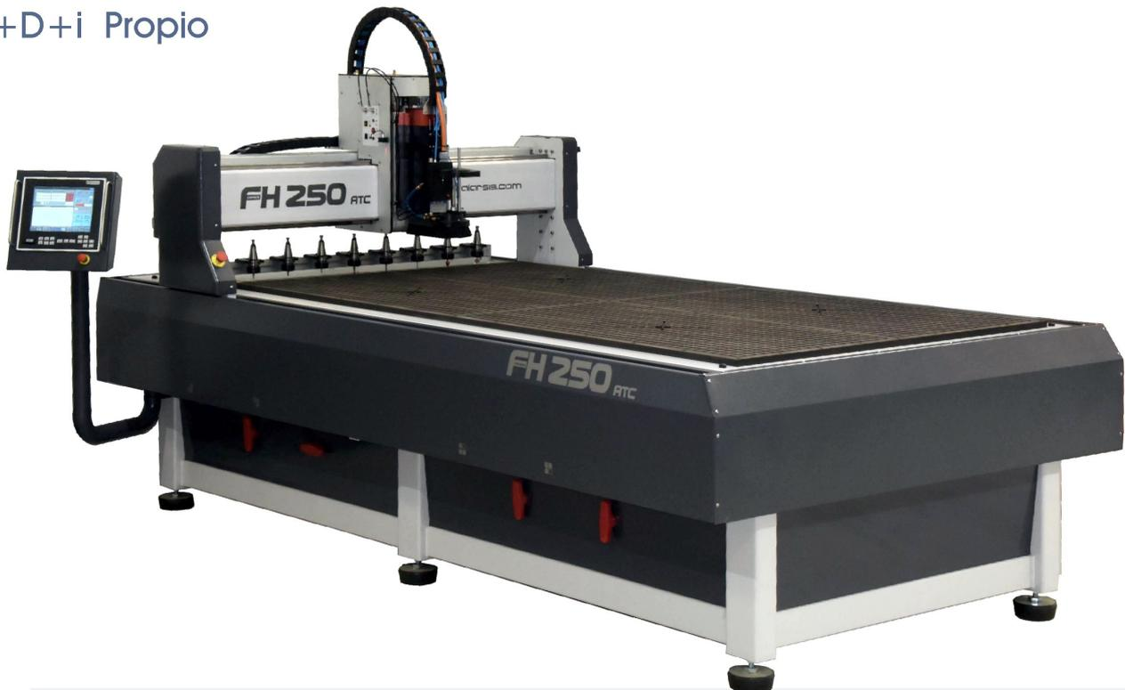
Modelo de producción y carga intensiva de trabajo para mecanizados donde se requieran prestaciones tanto de potencia como de precisión. Muy robusta y con bajo mantenimiento, características de toda la serie FH. Con transmisión por husillos a bolas en todos los ejes con nuestro exclusivo sistema de tuerca rotativa, motores servos y cambiador automático de herramientas en opción. Área útil de trabajo de 245x125cm y altura de 150mm.
